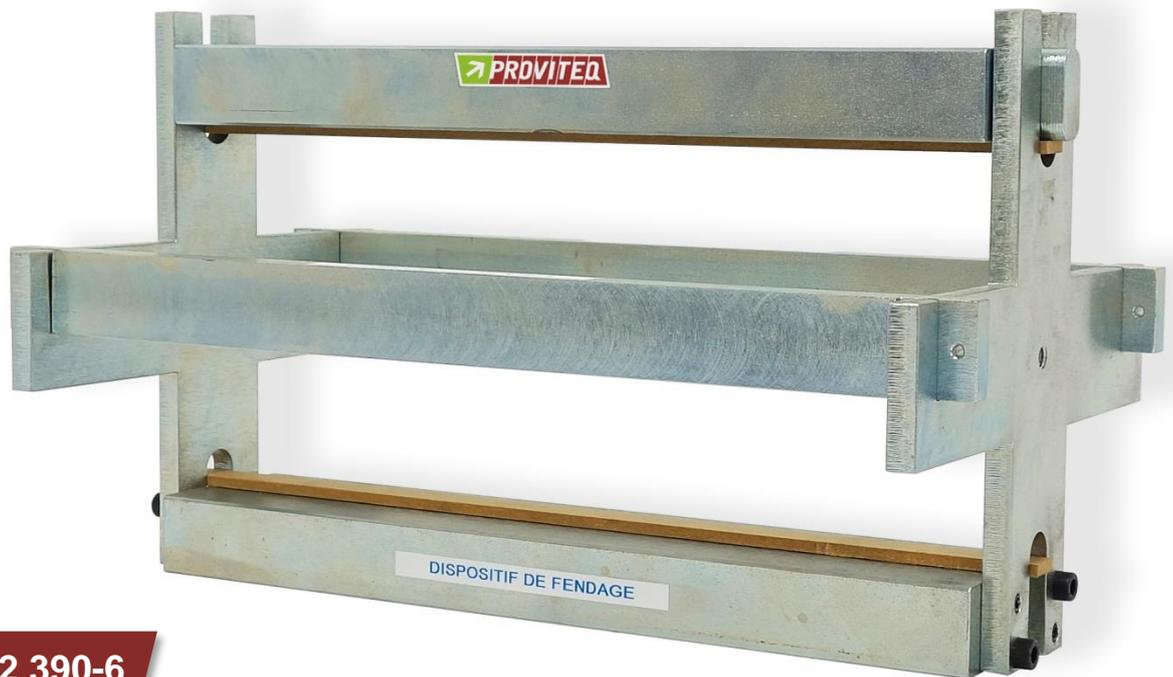
**NF EN 12 390-6****Mesure de la résistance au fendage des éprouvettes béton**
