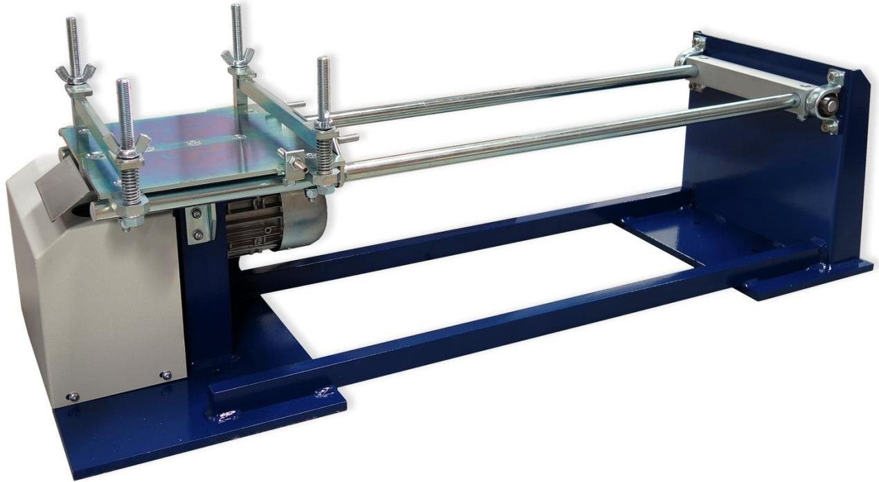
**NF EN 196-1****Serrage par battage du mortier**
