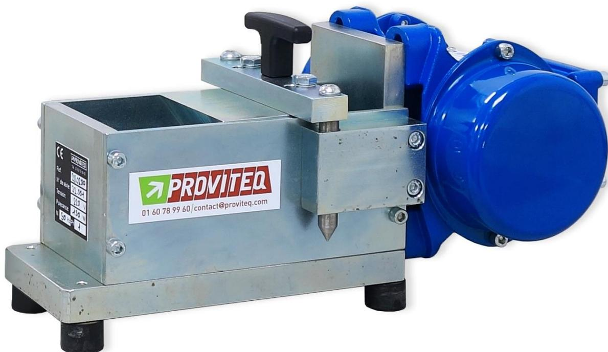
**NF P 18-452 – NF EN 413-2 – NF EN 459-2****Mesurer de la cohésion des mortiers de ciment de consistance normalisée**
