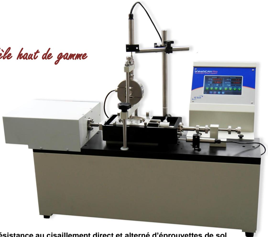
**Mesure de la résistance au cisaillement direct et alterné d'éprouvettes de sol**
