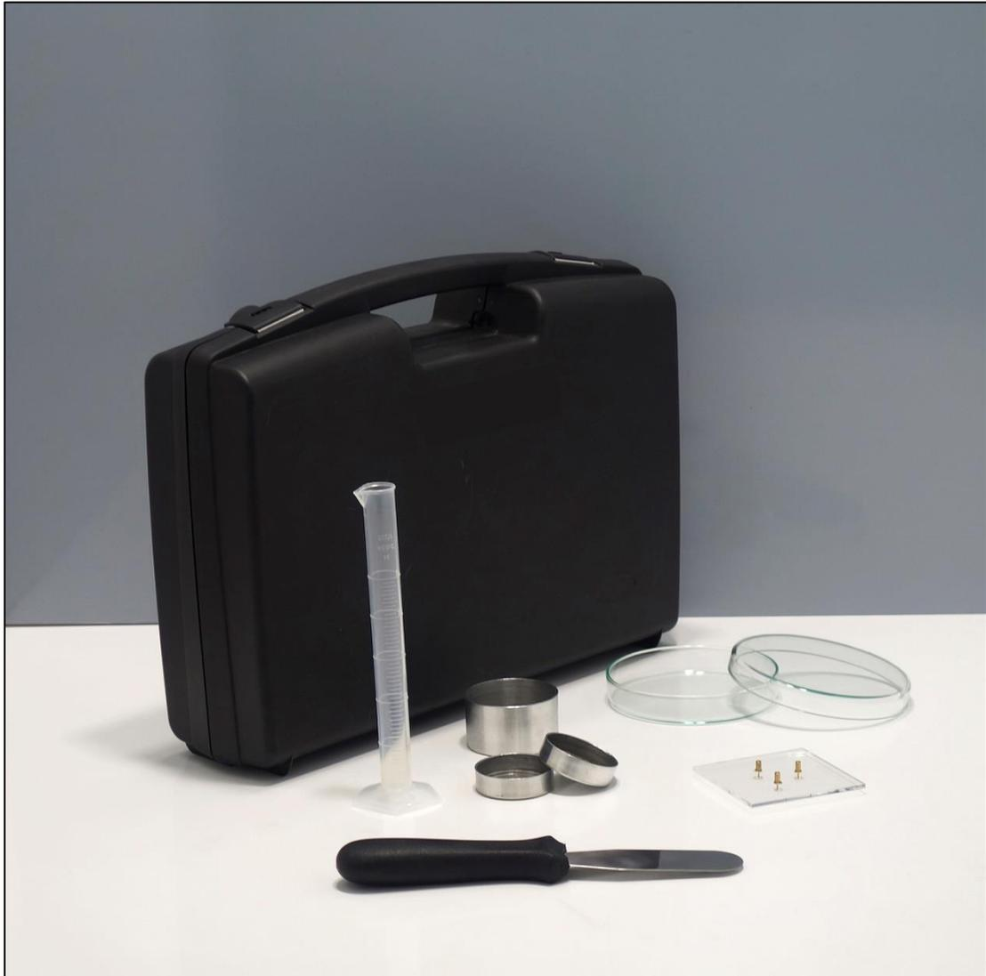
**XP P 94-060-1****Détermination conventionnelle de la limite de retrait sur le passant à 400 µm d'un matériau**
