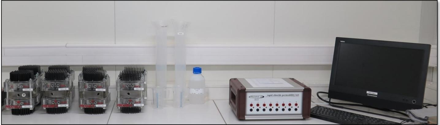
**NT BUILD 492****XP P18-461 – XP P18-462****ASTM C 1202-13 – ASTM C 1760****Pour la mesure de la pénétrabilité des ions chlorures dans le béton**
