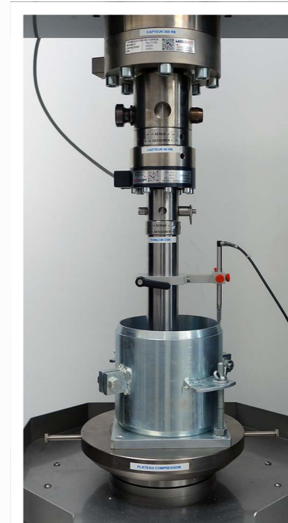
DISPOSITIF DE POINÇON / CBR
